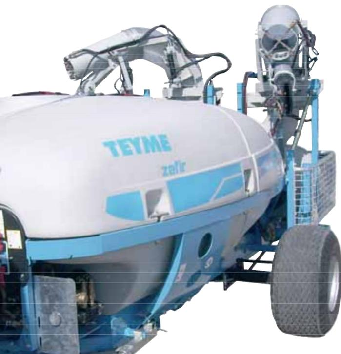
Equipo especial consistente en dos cañones **L.A.A. Largo alcance y altura** dispuestos en paralelo que permiten realizar tratamientos a dos caras en una pasada.
