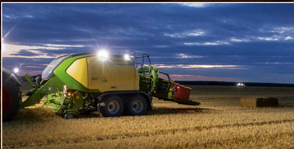
Iluminación de trabajo en los contenedores de hilo
