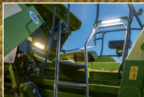
Iluminación de la escalerilla de acceso
