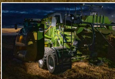
Iluminación detrás de los contenedores del hilo
